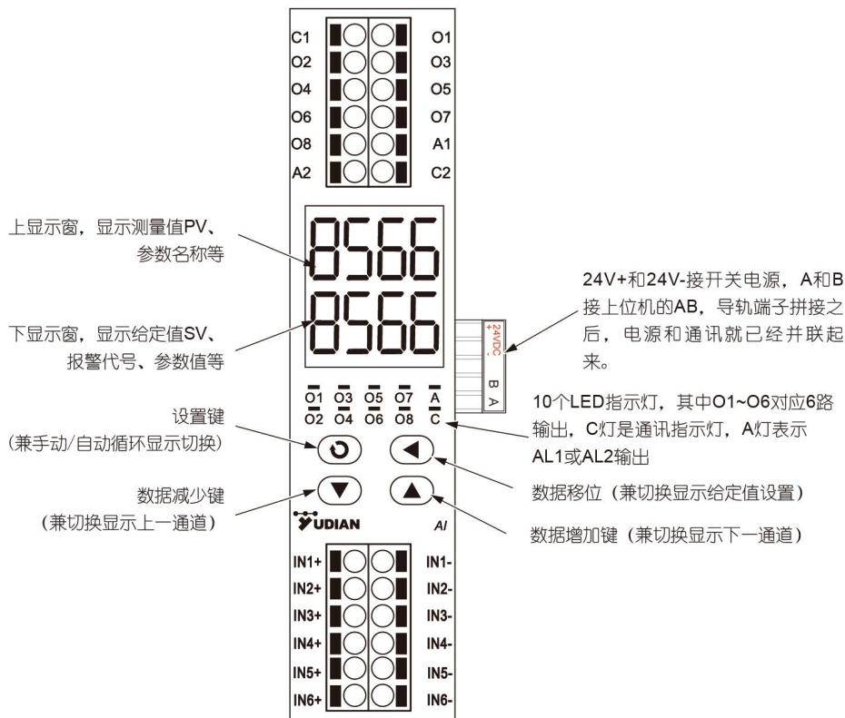
6 路热电偶输入接线分别接 INX+ 和 INX-, 以第一路为例, IN1+接热电偶的正, IN1-接热电偶的负。
